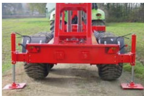
Podporni stabilizatorji, razpon do 3,3 m Podporni stabilizatori, raspon do 3,3 m Stützstabilisatoren Spannweite bis 3,3 m
