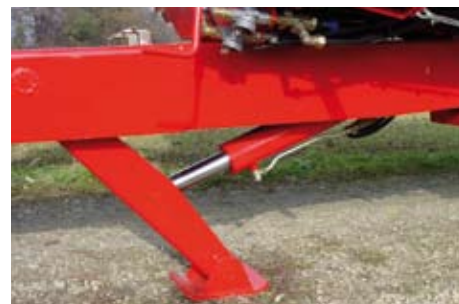
Hidravlična podporna stopa v Y-izvedbi Hidraulična podporna stopa u Y-izvedbi Stützfuß hydraulisch in Y-Variante
