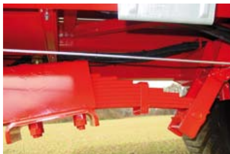
Vzmetena vlečna ruda z listnato vzmetjo Vučna ruda sa listnatom oprugom Zugdeichsel mit Federung
