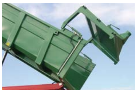
Hidravlično odpiranje zadnjih vrat Hidravlično otvaranje zadnjih vratiju Hydraulisches Öffnen der Rückwand
